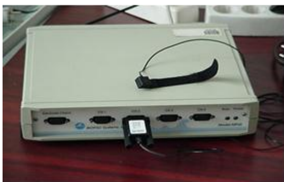
Figura X7. Echipamentul utilizat: unitatea de achiziție împreună cu senzorul pletismografic.
